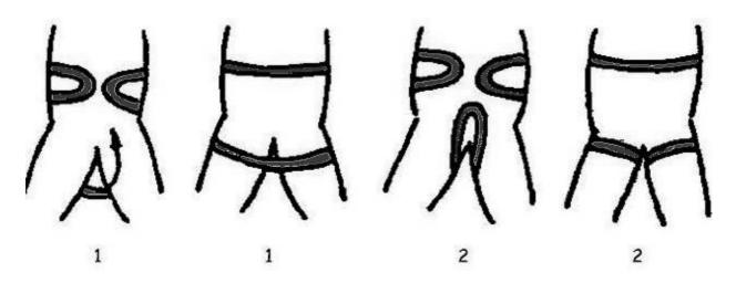
Die kurze schmalere Schlinge wird dann durch die <u>drei</u> Schlaufen die bei der Wickelung der breiten Schlaufe um den Körper vorne entstehen gesteckt und mit Ankerstich fixiert Auf dem Bild ist ein Ankerstich zu sehen. In der Schlinge die nur raus guckt wird dann der Schraubkarabiner angebracht. Das Bild rechts zeigt das Ergebnis.
